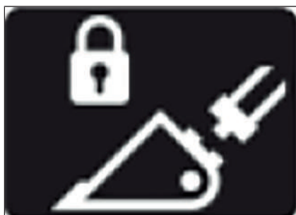
Fig. 188: Sistema hidráulico de cambio rápido cerrado
