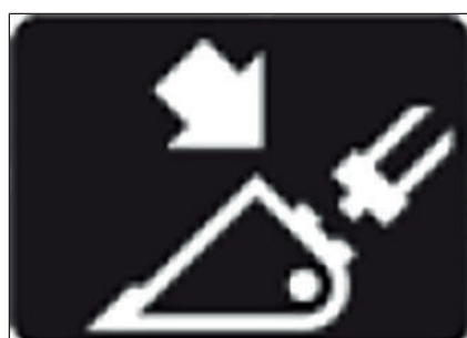
Fig. 183: Sistema hidráulico de cambio rápido activado
