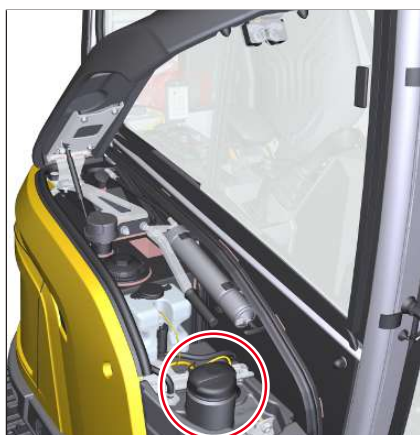
Fig. 246: Abertura de llenado para el combustible
