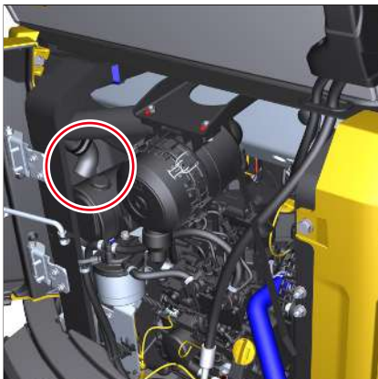
Fig. 269: Aspiración de aire
