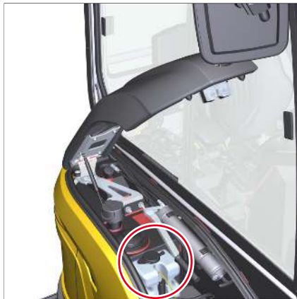
Fig. 256: Depósito de agua limpiaparabrisas
