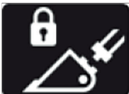
Fig. 205: Sistema hidráulico de cambio rápido cerrado
