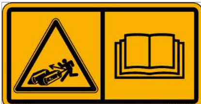
Fig. 23: Tensor de orugas
