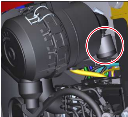
Fig. 268: Indicador de suciedad del filtro de aire
