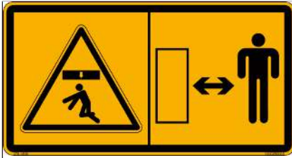
Fig. 17: Riesgo de aplastamiento, carga suspendida
