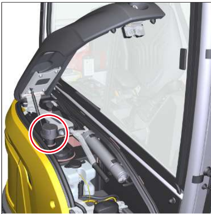
Fig. 245: Abertura de llenado de aceite hidráulico
