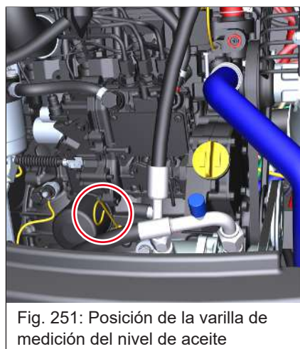
Fig. 250: Varilla de medición del nivel de aceite (representación simbólica)
