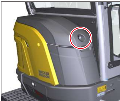
Fig. 240: Cubierta de mantenimiento 3
