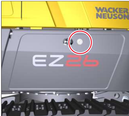
Fig. 239: Cubierta de mantenimiento 2
