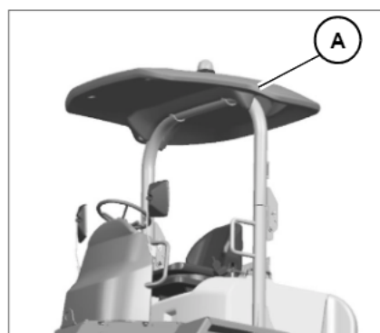
Fig.:64 Tejadillo de protección solar
