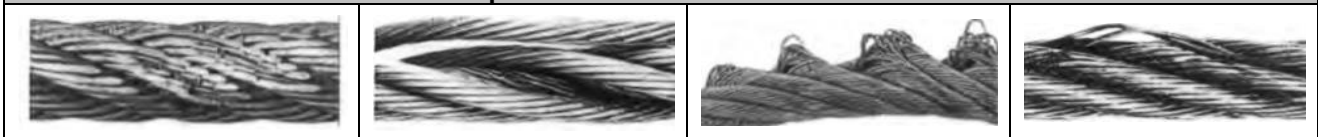
Ejemplos de desgaste de los cables de acero Examples of steel cables deterioration
